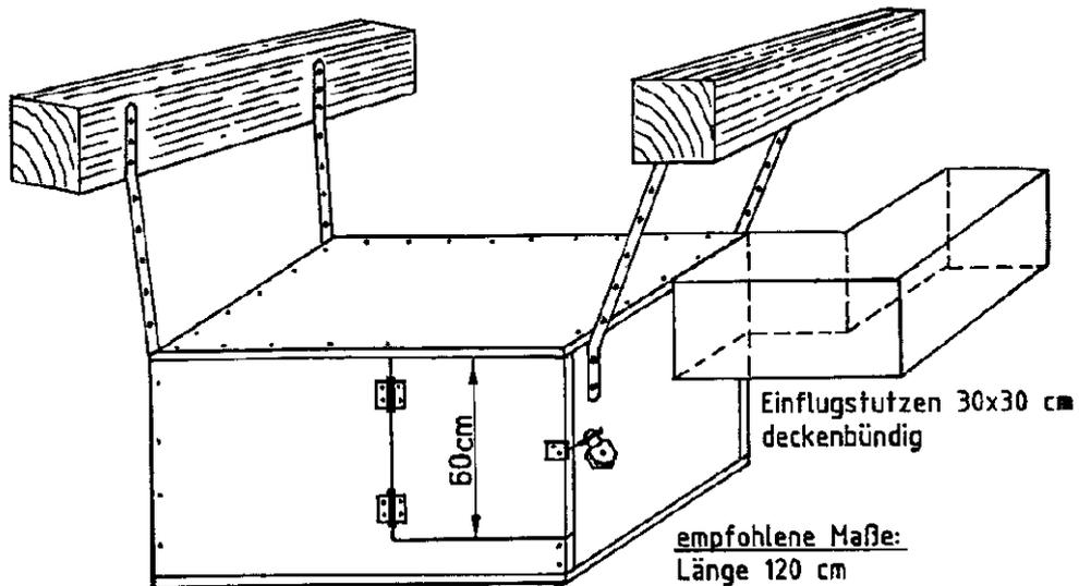
Freitragende Befestigung mit Metall-Montagelochband
